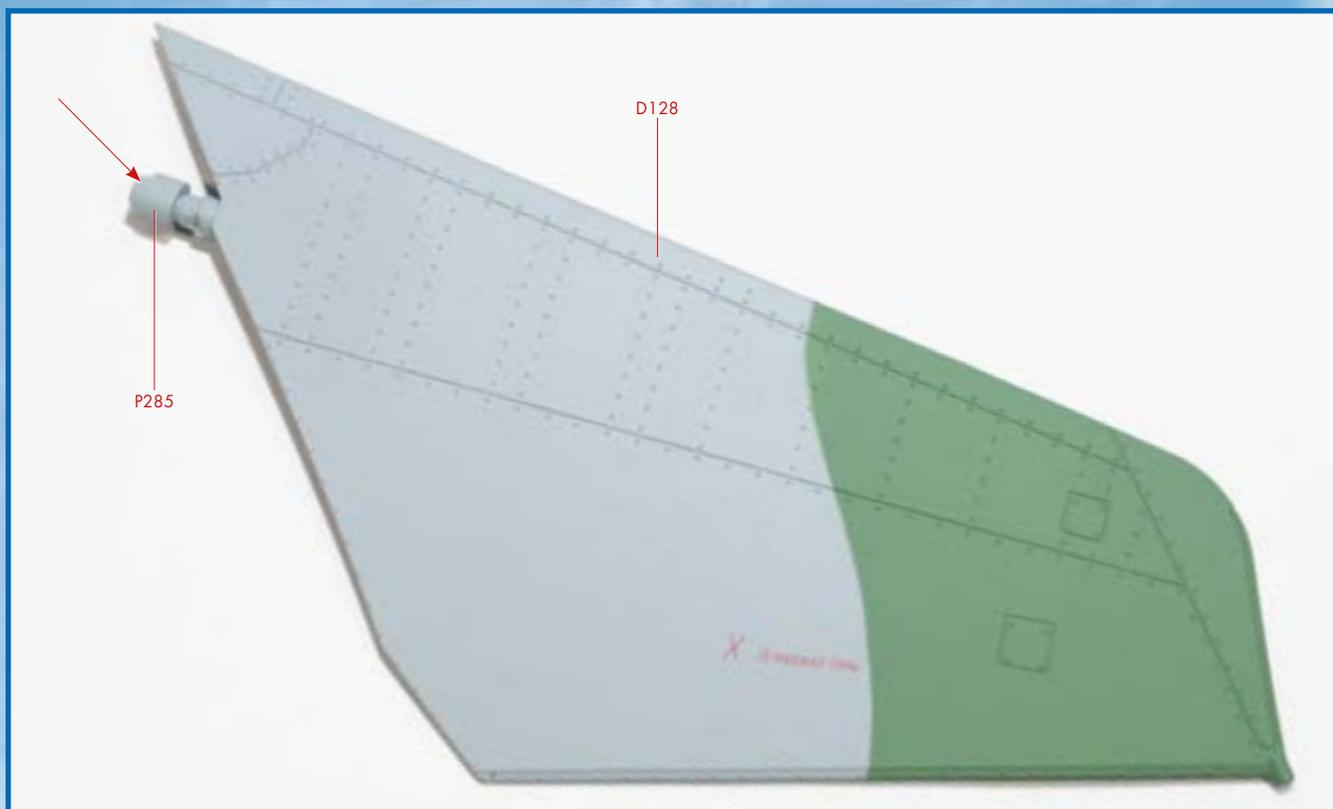
На этом этапе сборки вам потребуются детали, полученные с этим номером. Осторожно установите втулку (P285) на ось стабилизатора, как показано на снимке, а затем зафиксируйте ее винтом ВМ.
